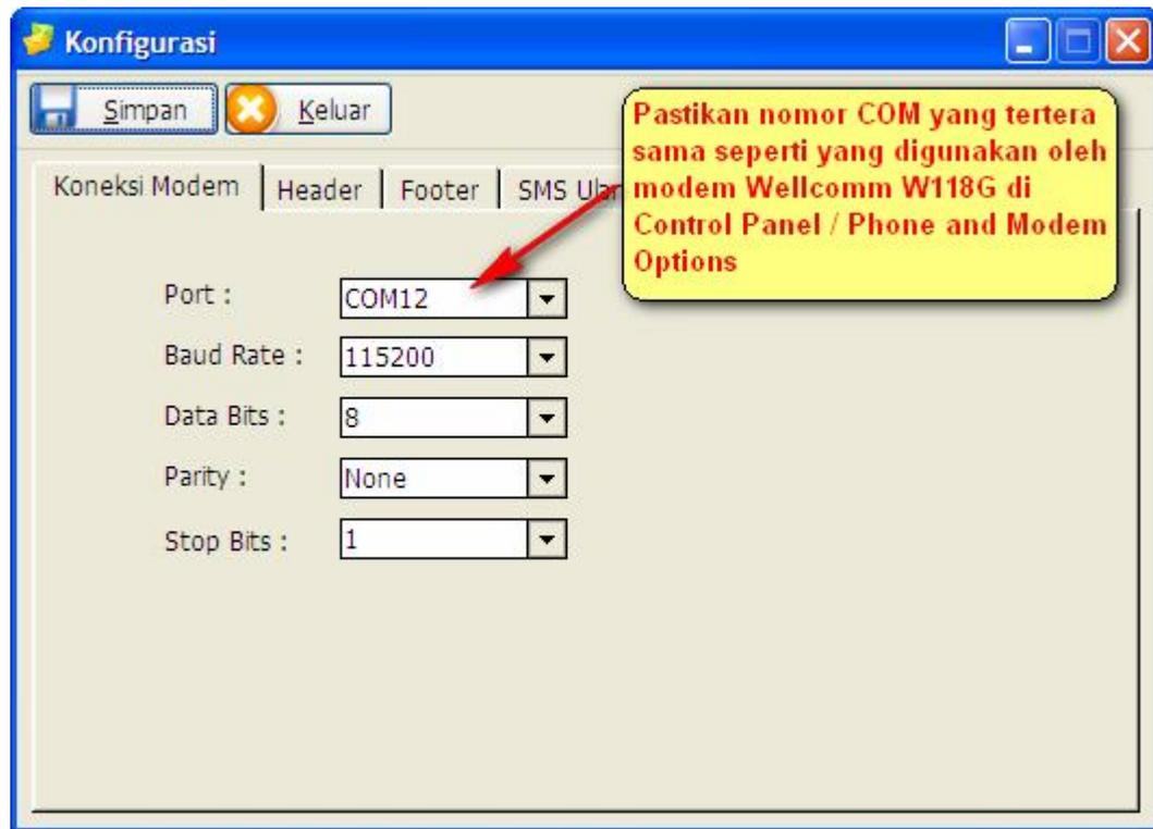
5. Untuk Baud Rate=115200 atau 921600, Data Bits=8, Parity=None, Stop Bits=1 (seperti gambar diatas)
